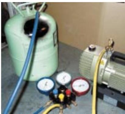
*Вакуумирование баллона вакуумным насосом через манометрический коллектор*
